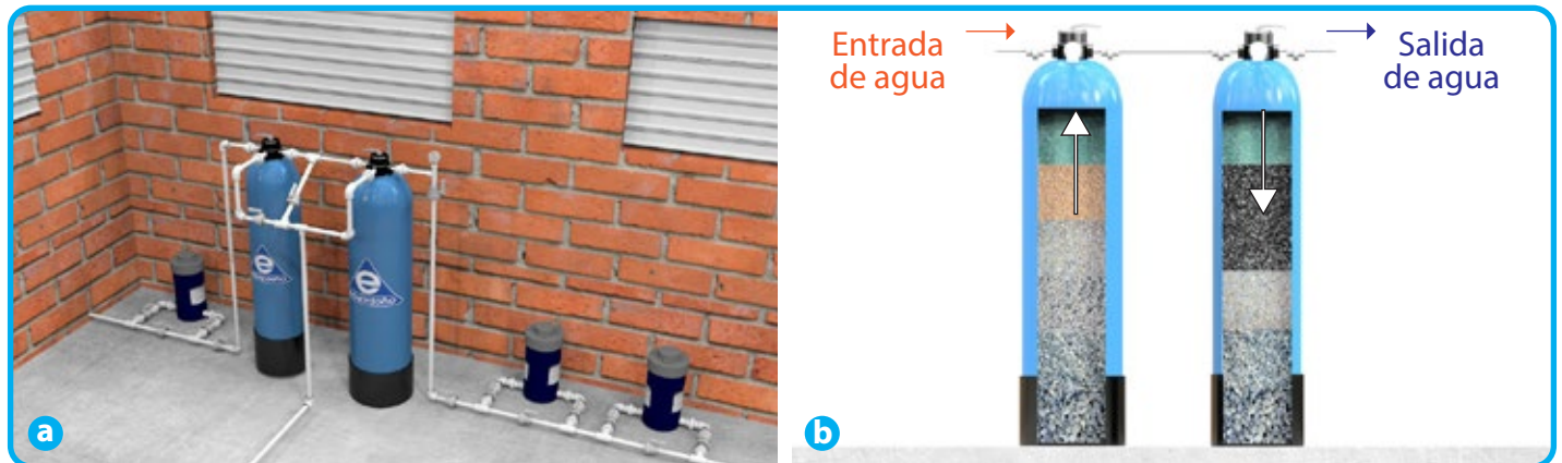
Figura 2. Esquemático 3D del sistema PTAP a presión
